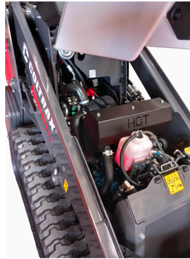
Accès frontal aux filtres du moteur, d'air et du carburant.
