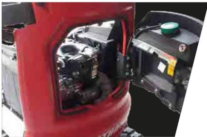
Le capot arrière, qui fait office de réservoir, permet un accès aisé pour son remplissage et pour le remplacement des filtres. Il permet de libérer de l'espace pour un meilleur refroidissement. L'accès au moteur se fait par le capot arrière ainsi qu'en soulevant le capot qui accueille le siège.
