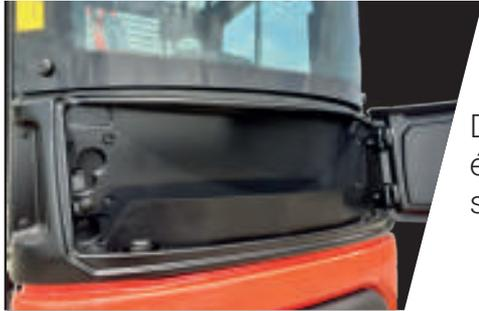
Dans les deux configurations (canopy ou cabine), la CX20 est équipée d'un rangement arrière spacieux et pratique, idéal pour stocker la documentation de la machine et le kit d'entretien.
