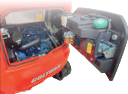
Le capot arrière, qui fait office de réservoir, permet un accès aisé pour son remplissage et pour le remplacement des filtres. Il permet de libérer de l'espace pour un meilleur refroidissement.
